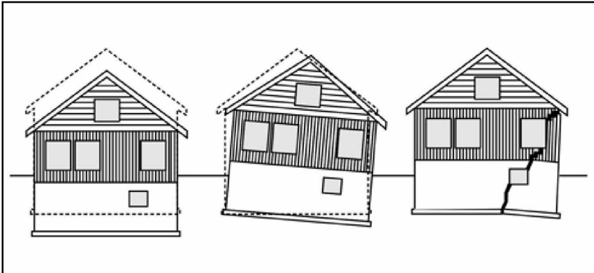
Typen zakkingen van gebouwen (gelijkmatig, scheefstand, lokaal)
