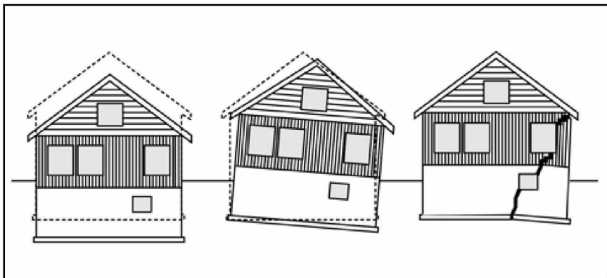
Typen zakkingen van gebouwen (gelijkmatig, scheefstand, lokaal)
