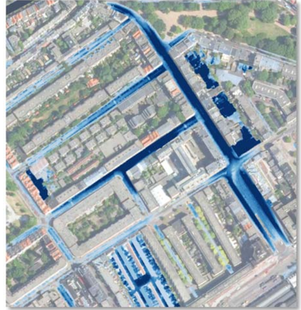
Figuur 4-1. In beide figuren staat de waterdiepte weergegeven aan het einde van de 100mm bui. Links staat het basis scenario, bij het rechterfiguur is het maatregelenpakket geschematiseerd
