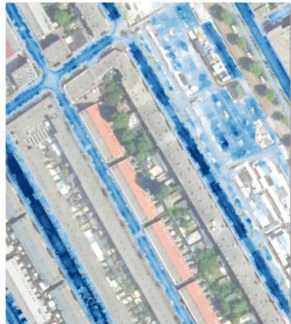
Figuur 4-2. In beide figuren staat de waterdiepte weergegeven aan het einde van de 100mm bui. Links staat het basis scenario, bij het rechterfiguur is het maatregelenpakket geschematiseerd
