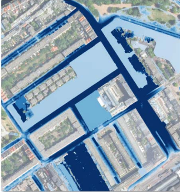
Figuur 4-1. In beide figuren staat de waterdiepte weergegeven aan het einde van de 100mm bui. Links staat het basis scenario, bij het rechterfiguur is het maatregelenpakket geschematiseerd
