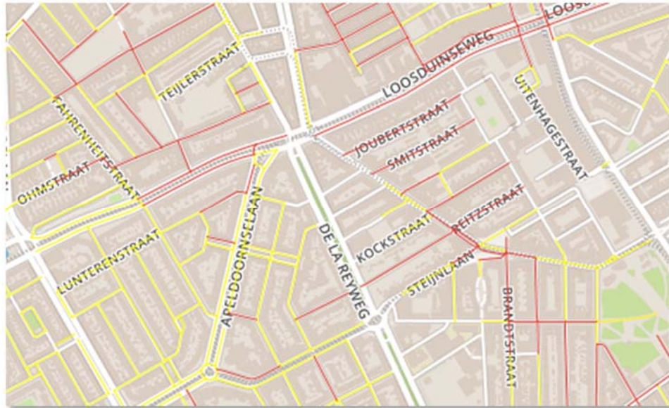
Figuur 3-6. Op de kaart staan de kwetsbare wegen bij een bui van 100 mm in twee uur aangegeven. De gele wegen zijn onbegaanbaar voor normaal verkeer, de waterdiepte is meer dan 20 cm. De rode wegen zijn ook onbegaanbaar voor calamiteiten verkeer, de waterdiepte is meer dan 30 cm
